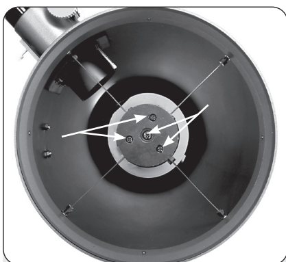
Fig. 31b: Le quattro viti di collimazione sull'alloggiamento dello specchio secondario
