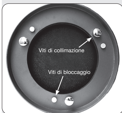
Fig. 31c: Sei viti sul retro della cella dello specchio primario.
