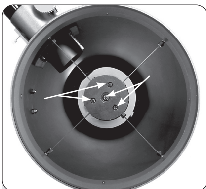
Obr. 31 b: Čtyři kolimační šrouby na pouzdru sekundárního zrcadla
