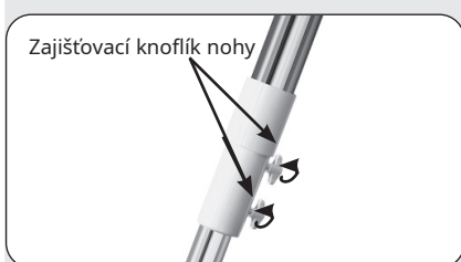
Obr. 11: Výšku stativu nastavte pomocí zajišťovacích knoflíků nohou.
