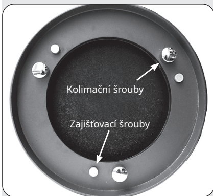
Obr. 31 c: Šest šroubů na zadní straně objímky primárního zrcadla.
