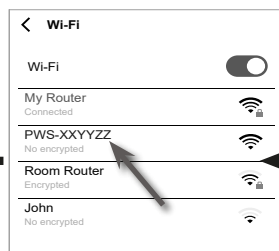
(d) Selecteer de WI-FI-netwerknaam van het basisstation (de naam begint altijd met PWS-) om uw smartphone met het basisstation te verbinden. Ga vervolgens terug naar de WSLink-app.
