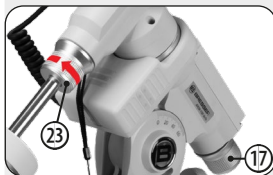
Fig. 23: DEC-Klemmung lösen und Tubus drehen
