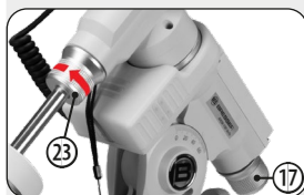
Fig. 23: DEC-klemming losmaken en buis draaien
