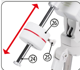
Fig. 22: Gegengewichtsklemmschraube lösen und Gegengewicht verschieben
