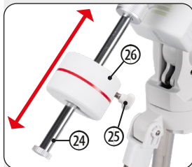
Fig. 22: Contragewichtsklem-schroef losmaken en contragewicht verschuiven
