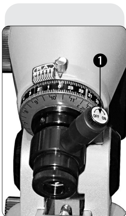
Fig. 6 : Vue détaillée du chercheur polaire avec commutateur rotatif (ON/OFF)
