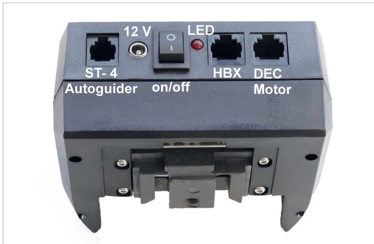
Fig. 1b :La carte de connexion du moteur RA
