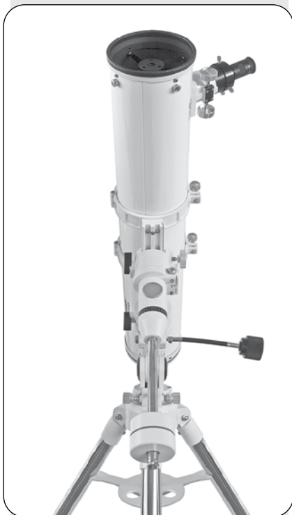
Fig. 3b : La position de départ équatoriale – ici sur un Newton – vue depuis le nord.
