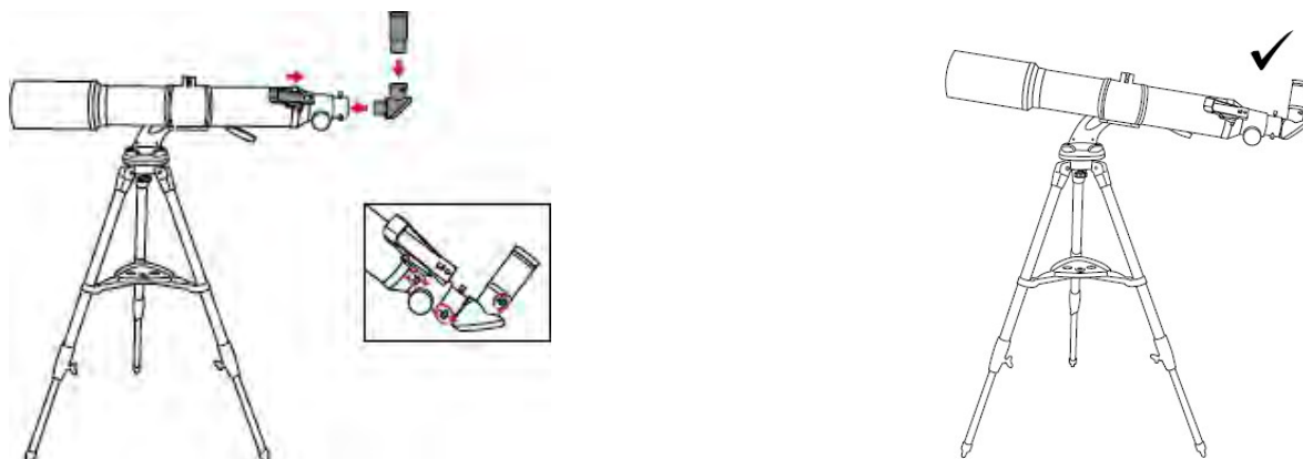
Figura 5: Montaje del buscador, el engranaje angular y el ocular en el tubo óptico
