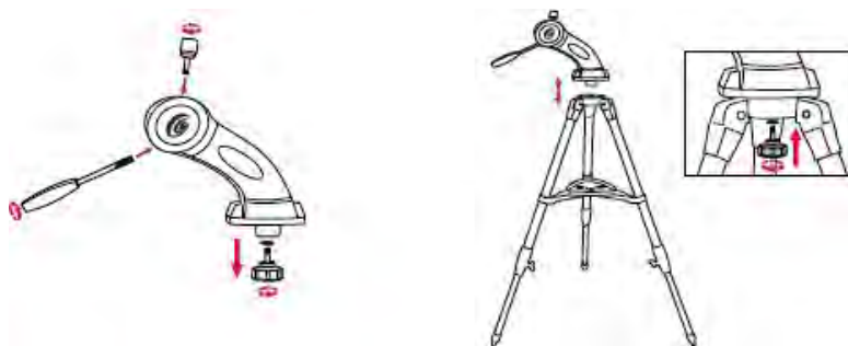
Abbildung 2: Montage der Montierung auf dem Stativ
