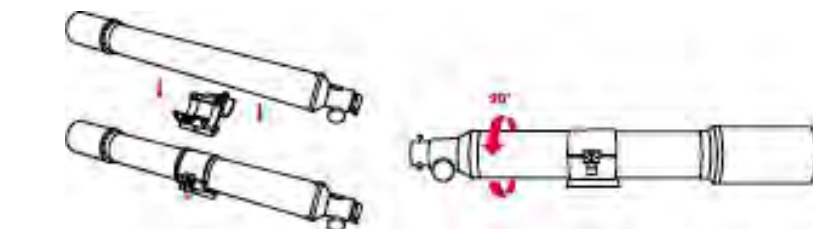
Abbildung 3: Montage der Rohrschelle am optischen Tubus
